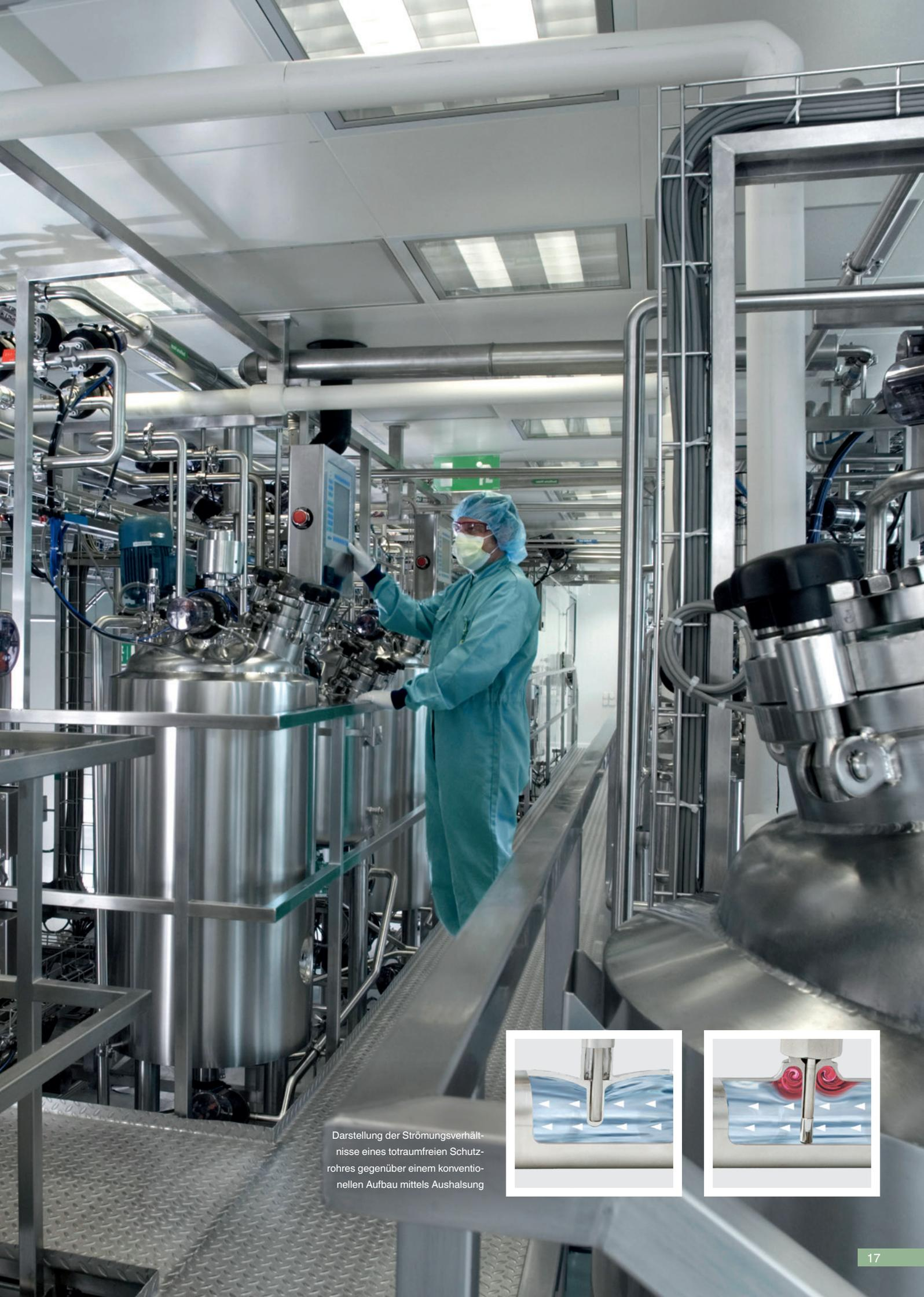
Darstellung der Strömungsverhältnisse eines totraumfreien Schutzrohres gegenüber einem konventionellen Aufbau mittels Aushalsung
