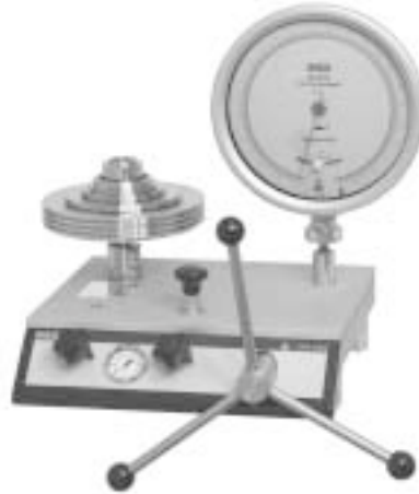
Грузопоршневой манометр CPB 5000 с калибруемым прибором
