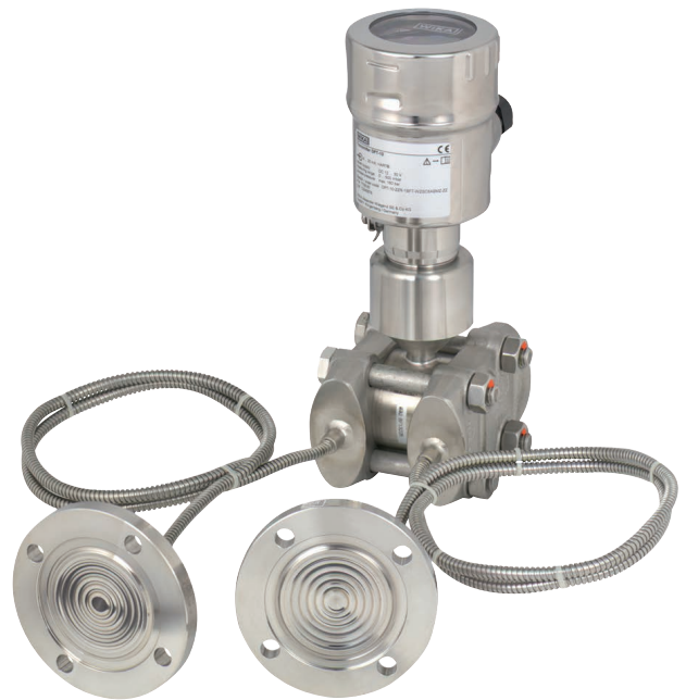
Transmisor de presión diferencial montado a través de un capilar en dos separadores tipo brida
