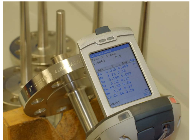
PMI-Test: Röntgenfluoreszenzanalyse des Schutzrohrschaftes
