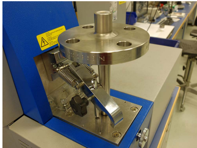
PMI-Test: Spektralanalyse an einem Flanschschutzrohr Typ TW10
