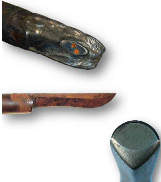
Danos em poços expostos a abrasão (exemplos)
