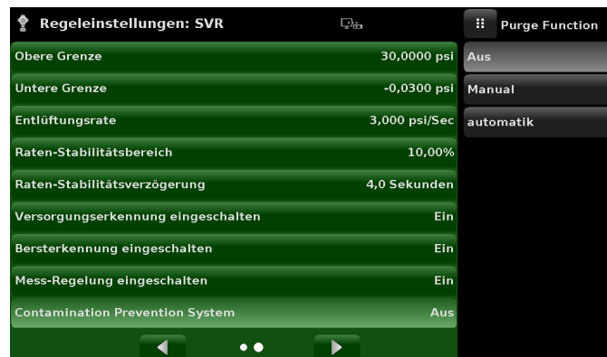
Abb. 8.9.2.3-B - System zum Schutz vor Verunreinigung
