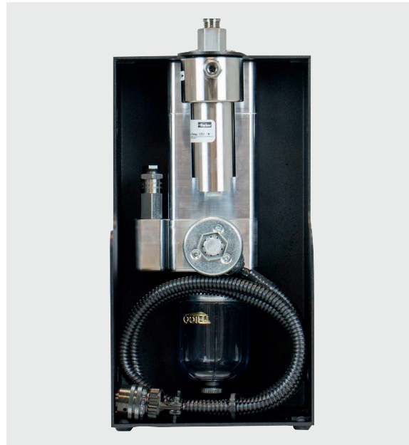
Abb. 8.9.2 - Automatisches System zum Schutz vor Verunreinigung
