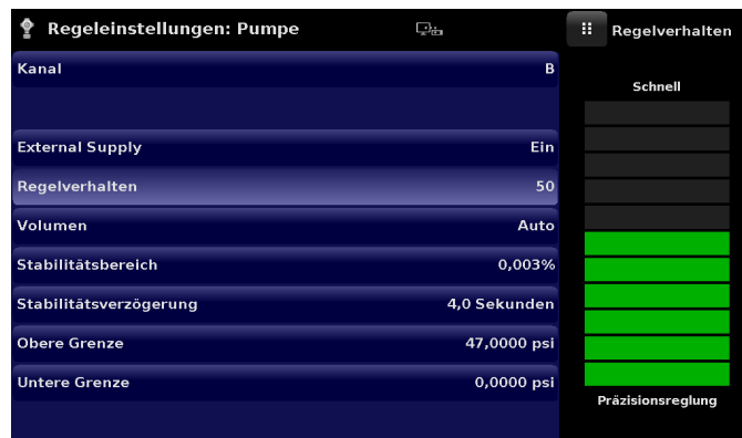
Abb. 6.4.3.3 - Regelverhalten des Pumpmoduls
