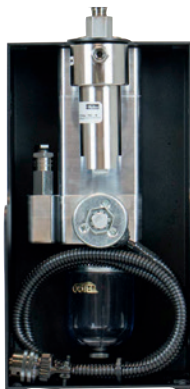
Figure 8.9.2 - Système automatique de prévention de la contamination
