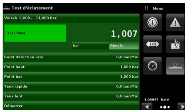
Figure 6.4.14 C - Test d'éclatement réussi (pas d'éclatement)
