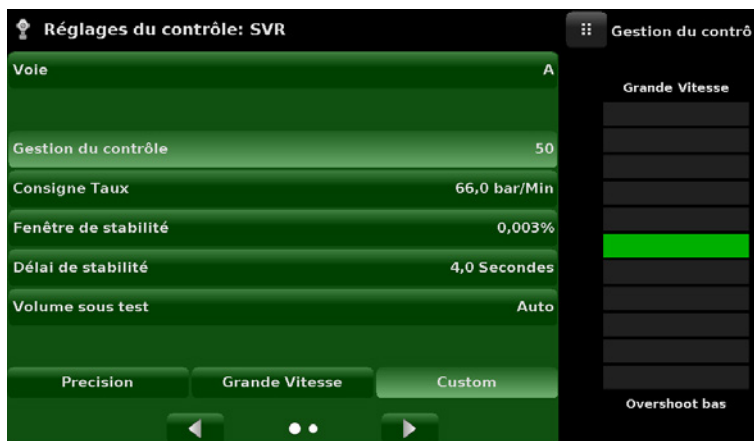
Figure 6.4.3.1 - Comportement de contrôle pour le module SVR
