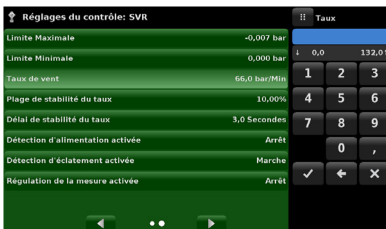
Figure 6.4.3.8 - Réglage du taux de mise à l'atmosphère
