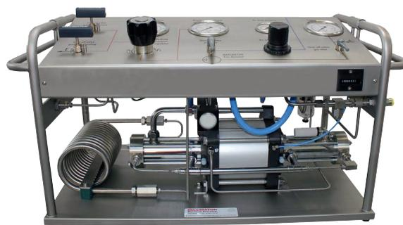
Abb. 4.9.4 – Hochdruck-Verdichterstation Typ CPK-PS400
