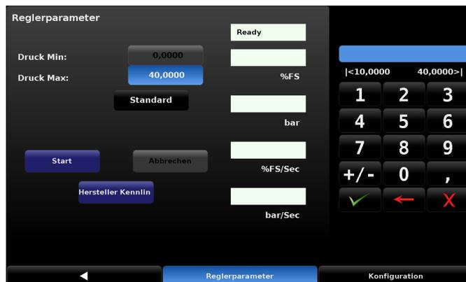
Abb. 7.5.7-B – Eingabe des Maximaldrucks
