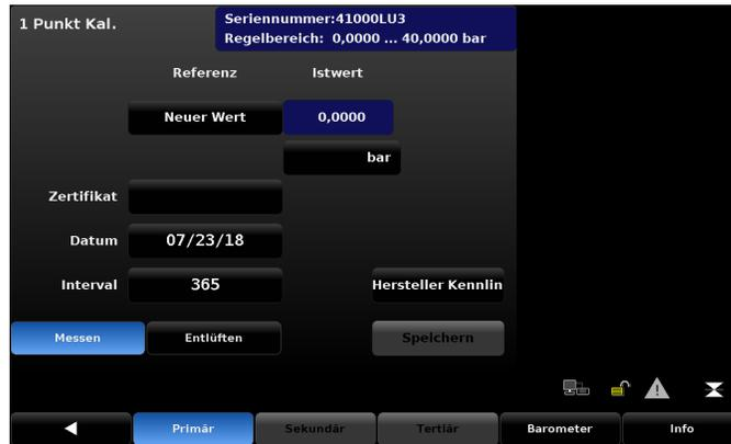
Nach Drücken der Schaltfläche [Zertifikat] kann eine Zertifikatsnummer eingegeben werden. Das Datum wird über die Schaltfläche [Datum] eingegeben. Das Kalibrierintervall kann über die Schaltfläche [Intervall] eingesehen und geändert werden.
