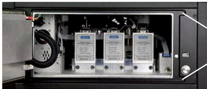
Schrauben zum Lösen der Frontplatte
