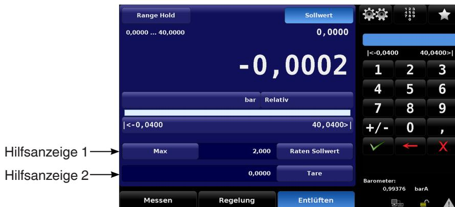
Abb. 6.3.11-A – Hilfsanzeige 1 und Hilfsanzeige 2
