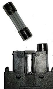
Abb. 10.1.2-B Austauschen der Sicherungen
