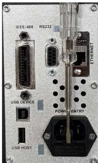
Abb. 10.1.2-A Position der Sicherungen
