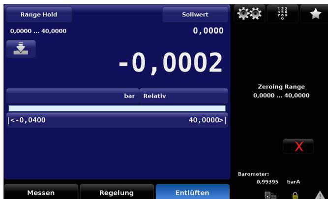
Abb. 6.3.16-A Nullabgleich aktiv im Relativdruckmodus
