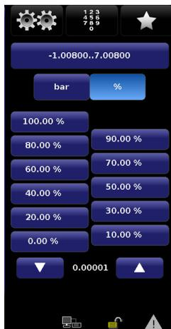
Hier kann ein Sollwert als Prozentsatz des Druckbereichs des Prüflings ausgewählt werden. Durch Drücken der gewünschten Schaltfläche kann zwischen verschiedenen Prozentwerten ausgewählt werden.
