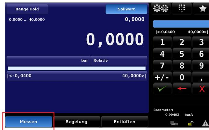
Wenn der Druck nicht im zulässigen Messbereich liegt, wird der Druckmesswert rot statt in weißen Ziffern dargestellt. Sobald ein Druck von etwa 110 % des Endwerts erreicht wird, öffnet sich ein integriertes Sicherheits-Belüftungsventil und lässt den Druck in das Innere des Geräts ab. Im Messmodus ist der Regler nicht aktiv.
