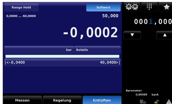
Wenn die Auflösung des Geräts auf 4 eingestellt ist, entspricht die Ziffer ganz rechts im Menü der niedrigstwertigen Stelle des Sollwerts, und die zwei linken Ziffern im Menü würden nicht verwendet werden.
