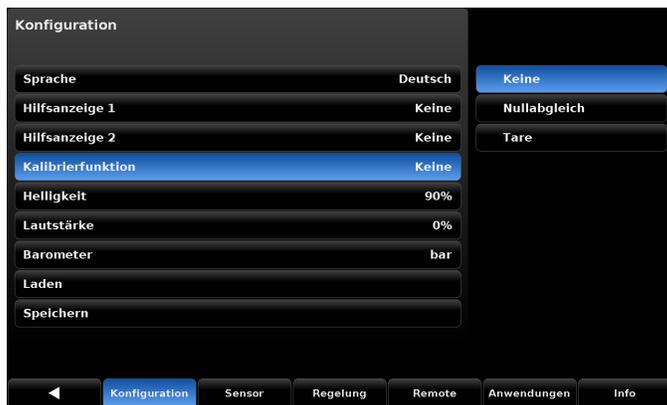
Die Abbildung 7.1.3-A zeigt, dass die Auswahl der Tare-Option mit der Hilfsanzeige übereinstimmt.
