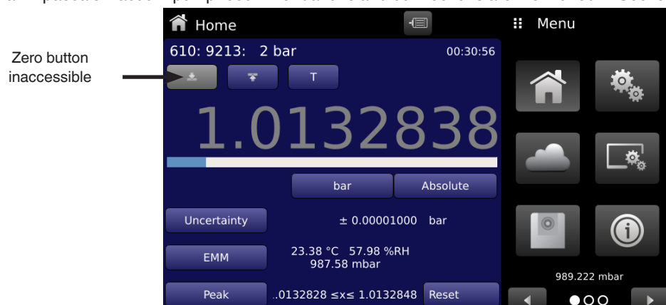
Figure 6.4.1.3.2 Inaccessible Zero Button
