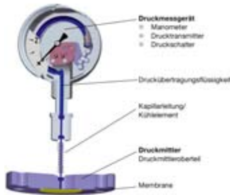
Anbau eines Druckmittlers via Kapillarleitung an ein Druckmessgerät
