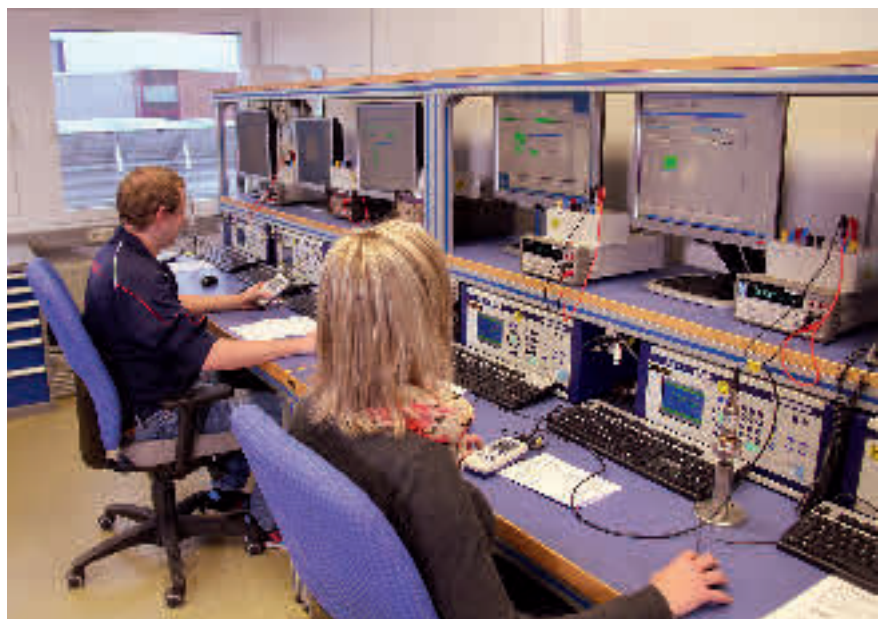
Bild 1. Bei der Kalibrierung elektrischer Druckmessgeräte fährt die Software den Druck auf Referenz und Prüfling an und liest den Messwert aus. Da viele dieser Prüfvorgänge nach dem Start automatisch ablaufen, kann ein Mitarbeiter mehrere Kalibrierplätze betreuen. © Wika
