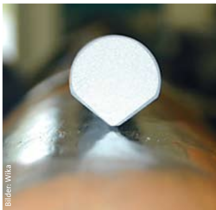
Das V-förmige Design des Thermometer-Körpers erlaubt eine durchgeschweißte Verbindung zur Oberfläche der Rohrleitung unabhängig von deren Durchmesser
