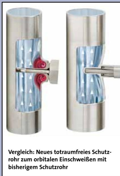
Vergleich: Neues tottraumfreies Schutzrohr zum orbitalen Einschweißen mit bisherigem Schutzrohr
