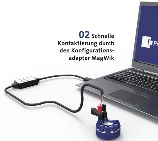
aus Konfigurationen vorgenommen und Informationen mit den Endgeräten ausgetauscht werden. Dabei handelt es sich neben DD (Device Description) und DTM (Device Type Manager) immer häufiger auch um Softwarebausteine, die auf der neuen FDT-Technologie (Field Device Tool) beruhen.
