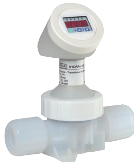
HD型HYDRA-line压力传感器4 ... 20 mA，2线制，带集成数显仪 (HYDRA-Indicator) 圆筒形1/2"扩口螺纹过程连接。
